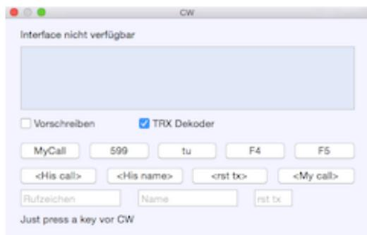
Für die Ausgabe per Tastatur steht auch das CW Fenster zu Verfügung: *Menü*–>*Fenster*–>*CW*. Bei aktivierter *Paddle Echo Back* Option werden selbst gegebene Zeichen in schwarzer Schrift ausgegeben. Dies kann man zum üben nutzen. **Eventuel im WinKey Chip vorhandene Speicher werden nicht unterstützt!** Dafür stehen aber die 5 ‘RUMlog Speicher’ zur Verfügung und lassen sich mit F1 -F5 starten.
