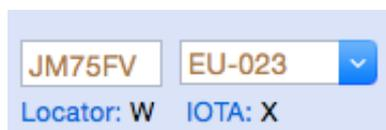
Der Locator (Maidenhead Grid Square) kann 4- oder 6-stellig und alles in Großbuchstaben angegeben werden. Die Angaben in der Station Info Box werden entsprechend der Eingabe präzisiert. Der Text kann in verschiedenen Farben dargestellt sein:
